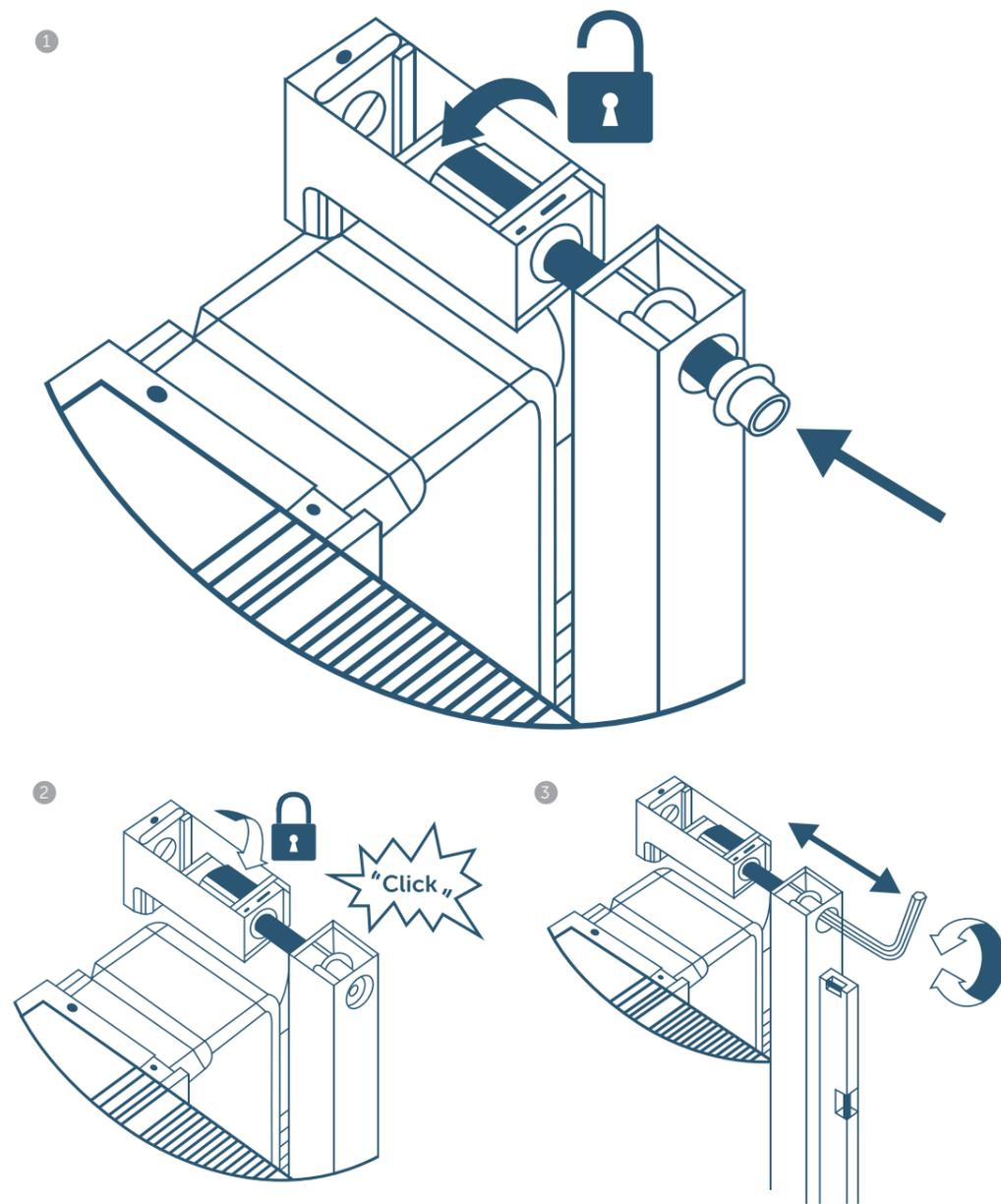
1. Insérez la tige filetée dans le trou alloué du bâti-support et positionnez le cadran sur « déverrouillé » et enflez-la sur la barre.
