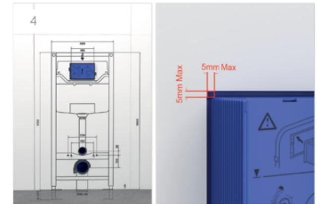
4 Mettre en place l'habillage du bâti support en utilisant le gabarit fourni sur l'emballage du bâti support. Un espace de 5 mm max est à prévoir autour de la trappe de visite.
