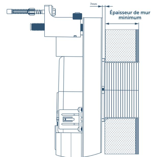
\* Aucune épaisseur minimum requise car la plaque de commande n'est pas installée à l'avant du réservoir.
